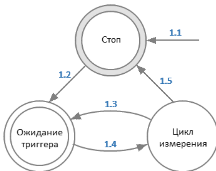
Рисунок 50 — Состояния и переходы анализатора
