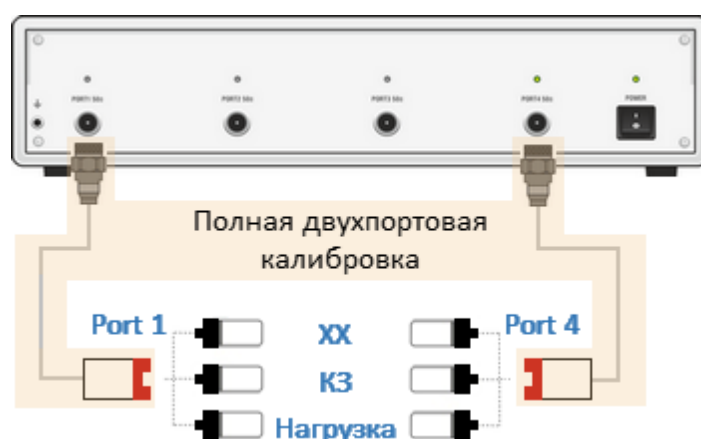
Рисунок 127 – Первый этап калибровки с неизвестной перемычкой SOLR
