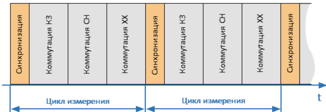
Рисунок 148 – Временная диаграмма рабочего цикла модуля
